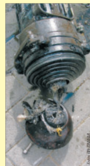
Gummihandschuhe und verzapfte Fasern legten das Abwasserpumpwerk am Kastanienplatz in Wünsdorf lahm. So ergeht es im Bereich des KMS Zossen auch den Anlagen am Friedhofsweg in Zossen, in Dahlewitz (Bertolt-Brecht-Straße), im Recyclingpark Töpchin sowie in Rangsdorf am Stichweg Ecke Seebadallee.
