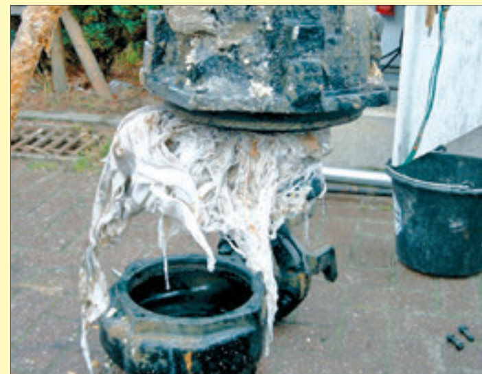
Dieser Pumpe fehlte nichts, bis sie „verbunden“ wurde – oder wofür war das in die Kanalisation entsorgte Verbandsmaterial gedacht? Im WARL-Entsorgungsgebiet fallen auch die Station in Gröben und das Abwasserpumpwerk in Glau (Friedensstadt) regelmäßig aus.
